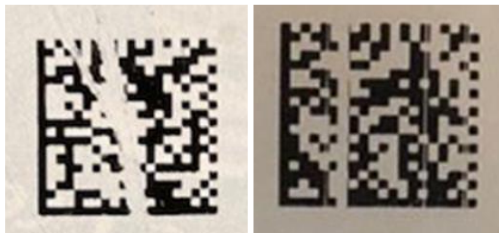
Нарушение целостности КМ*
